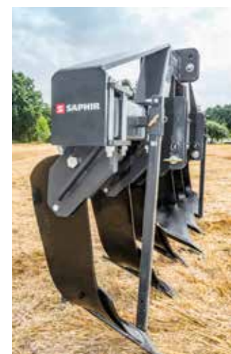
Robuster Vierkantrahmen zur optimalen Kraftaufnahme.
