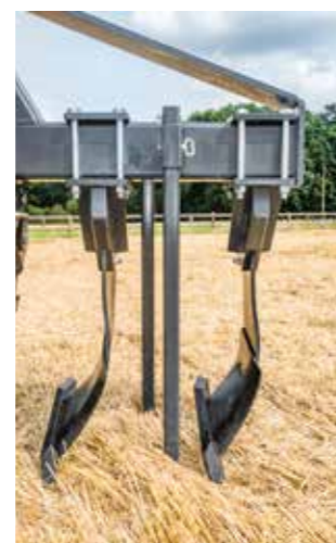
Die speziell geformten Schare heben den Unterboden an und lockern ihn dadurch auf der gesamten Arbeitsbreite. Anlagebleche und Scharspitzen können bei Verschleiß einzeln ausgetauscht werden.
