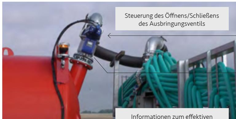
Steuerung des Öffnens/Schließens des Ausbringungsventils
